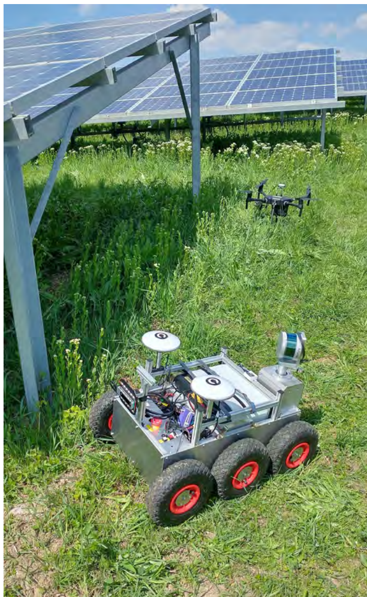
Testlauf eines automatisierten Robotersystems zur Wartung von Solarparks. Seit drei Jahren wird es von Wissenschaftlern mit der Firma Suntec entwickelt.
