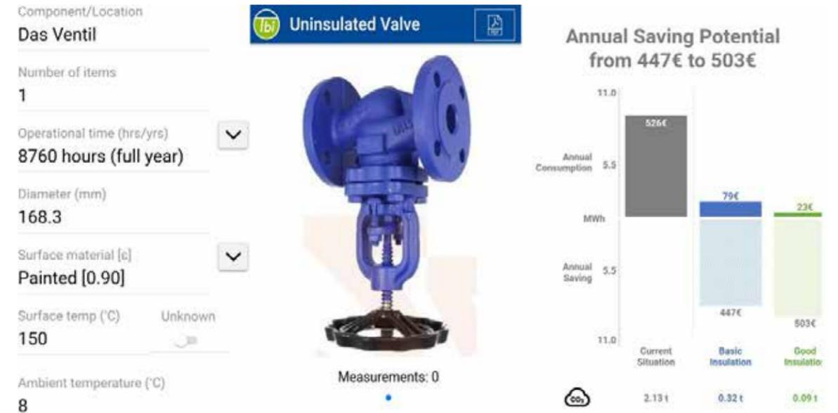
Abbildung 4: Auswertung der TBI-App. Links sind die eingegebenen Parameter abgebildet, in der Mitte das Ventil und rechts das Einsparpotenzial in kWh, CO<sub>2</sub> und Euro.
